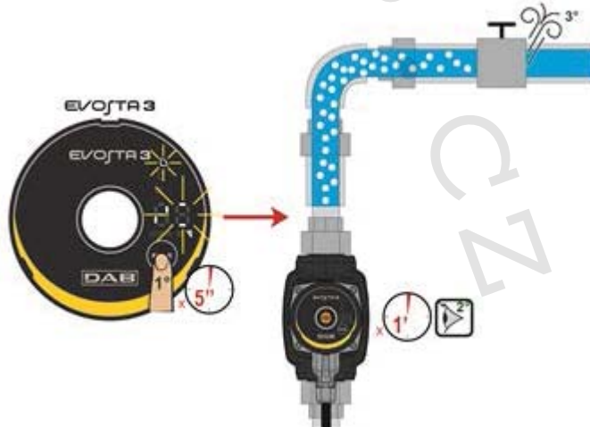
Obrázek 9: Automatické odvzdušnění čerpadla
