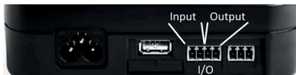
Obrázek 21: DCONNECT BOX2 VSTUP/VÝSTUP
