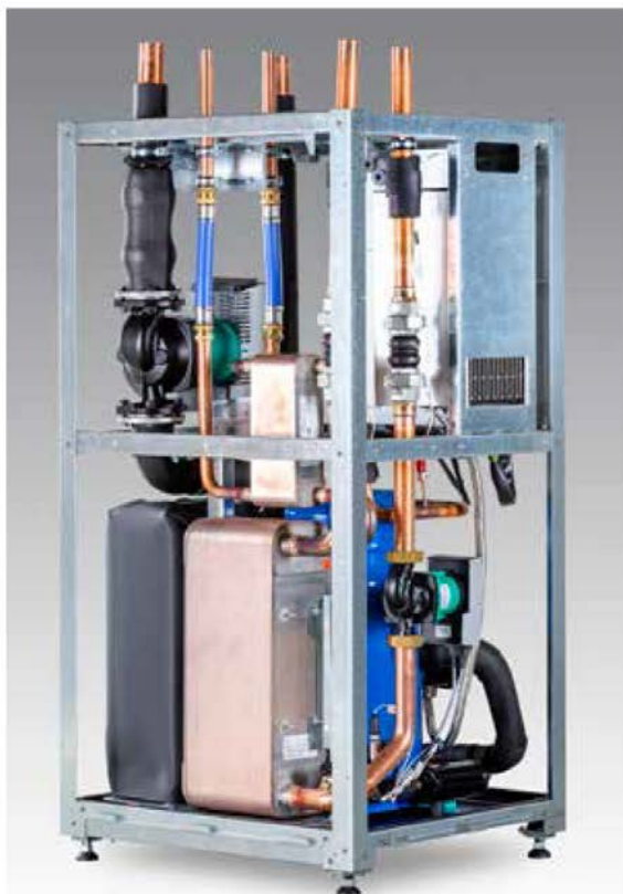
Obr. 5: Tepelné čerpadlo Mega, konfigurace jeho dílů a umístění výměník přehřátých par pro přípravu TV během vytápění.
